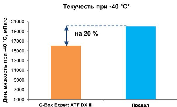
G-Vox Expert ATF DX III сохраняет высокую течучсть в сильные морозы, обеспечивая плавное начало движения в суровых климатических условиях.
