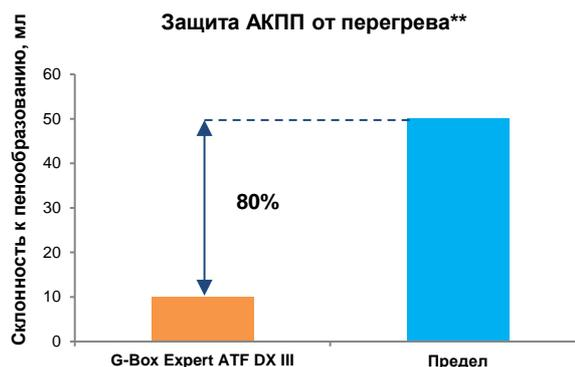
G-Vox Expert ATF DX III имеет низкую склонность к пенообразованию, защищая агрегаты трансмиссии от перегрева при высоких скоростях вращения деталей.
